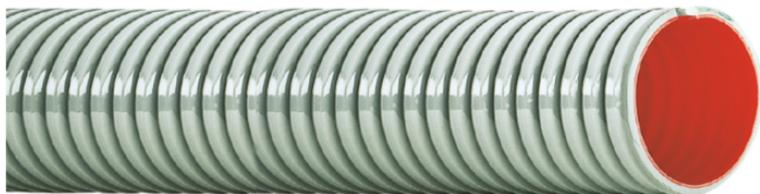
**Abriebfester Kunststoff Saug- und Druckschlauch mit PU-Innenseele mit Kupferlitze zur Ableitung der elektrostatischen Aufladung.**
